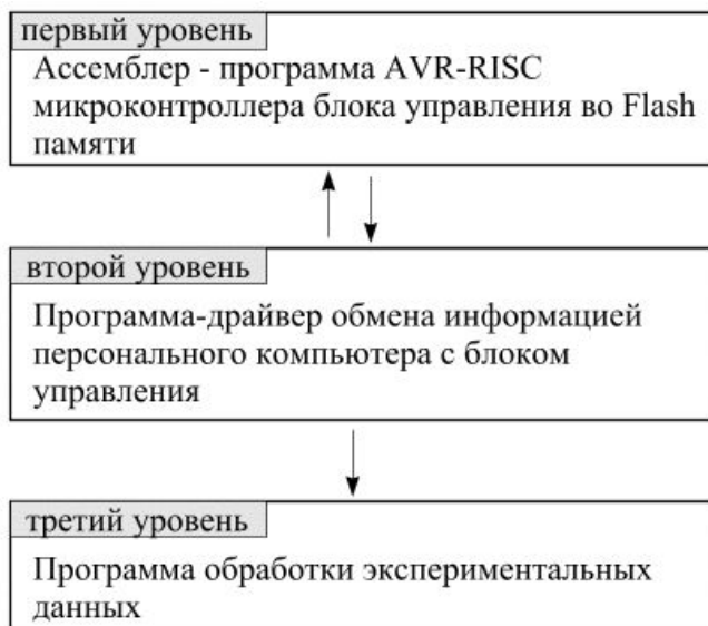
Рис. 3. Функциональная схема взаимодействия программ АСМОИ.
