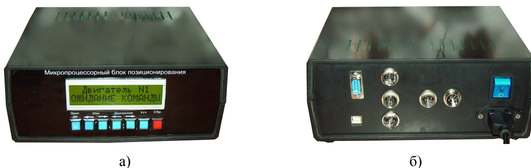
Рис. 2. Микропроцессорный блок АСМОИ: а) вид со стороны лицевой панели; б) вид со стороны разъемов управления, съема и передачи информации.
