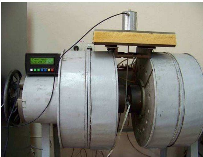
Рис. 1. Микропроцессорный блок в составе автоматизированной установки вибромагнитометра.
