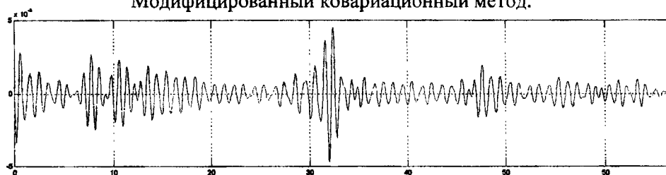
Рис. 6. Реализация, полученная интерферометром-деформографом с 06 ч 58 м (10.06.02) до 00 ч 33 м (16.08.02). Диапазон периодов: 14 ч – 22 ч.
